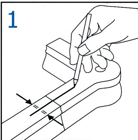
Отметьте центральную линию длиной 100 мм на тыльной стороне каждой из соединяемых деталей поручня.
