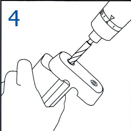
Приложите шаблон к детали, в которой уже просверлено отверстие для редуктора, чтобы осевая линия была видна через отверстия и точно совпадала с метками на шаблоне. После этого плотно прижмите шаблон к торцу детали и сделайте отверстие Ø9,5 мм для шпильки.
