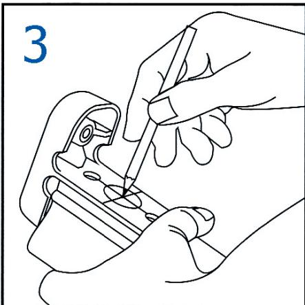
Карандашом отметьте центр отверстия Ø25 мм на нижней стороне поручня, затем снимите шаблон и просверлите первым сверлом отверстие глубиной 35 мм для редуктора.
